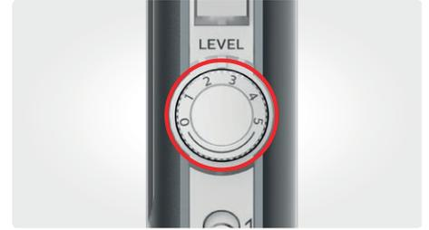
Für die bessere Steuerung von Aufnahmen lässt sich der Eingangspegel auf bis zu -20 dB regeln.
